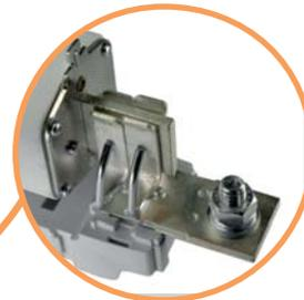
→ Ножи предохранителя посеребрены и выполнены в конусной форме, что позволяет устанавливать предохранитель в держатель с меньшим усилием
