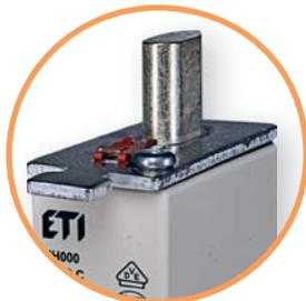
→ Корпус предохранителя выполнен из стеатита - термически устойчивого материала. Ножевые контакты изготавливаются из латуни с напылением серебра. Торцевые крышки выполнены из алюминия, что обеспечивает длительную защиту от коррозии. Корпус заполнен специальным кварцевым песком строго определенной грануляции, что гарантирует высокую отключающую способность и стабильность параметров защиты
